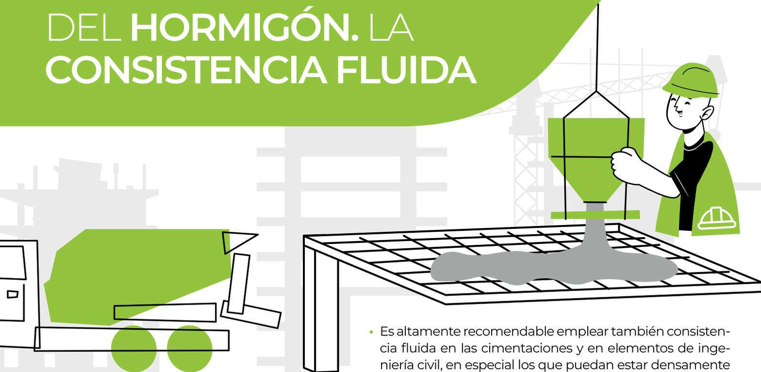
**La trabajabilidad del hormigón depende de su docilidad que debe ser la adecuada para facilitar su colocación de forma que rodee perfectamente las armaduras y rellene completamente los encofrados sin que se produzcan coqueas.<sup>1</sup>**
